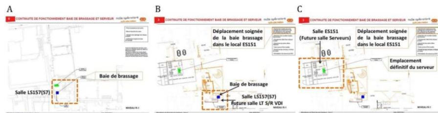
Figure 8. Continuité de fonctionnement des serveurs. A : Validation des repérages des réseaux existants. B : Salle LS157 (S7). C : Salle ES151.
